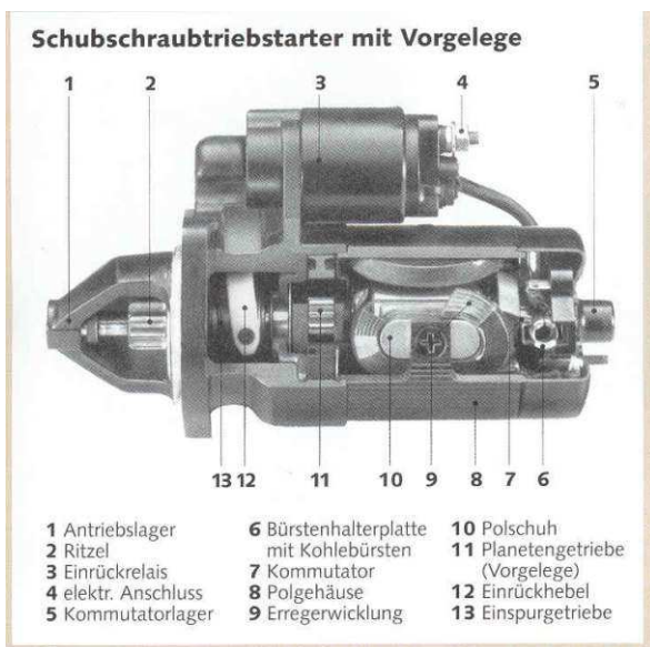
Bild 6 Schraubtriebstarter mit Vorgelege
