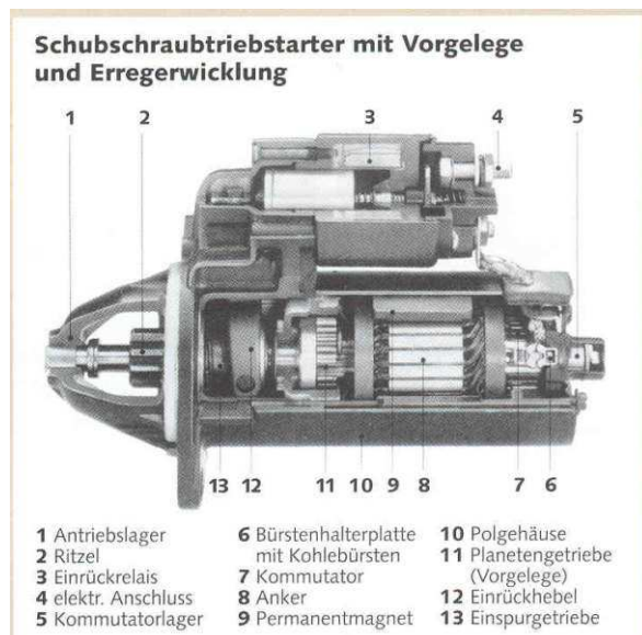
Bild 7 Schubschraubtriebstarter mit Vorgelege und Erregerwicklung
